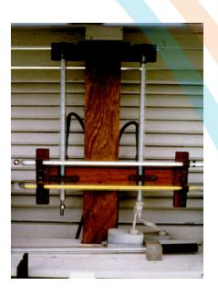
Dry-bulb, wet-bulb thermometer
